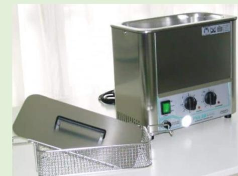
Bagno ad ultrasuoni per il lavaggio della strumentazione
